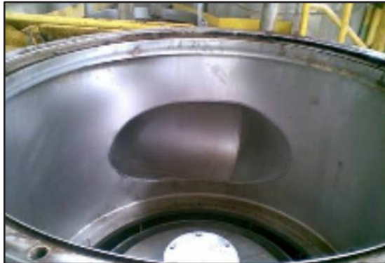
Carcasa de criba después de preparación de superficie.
